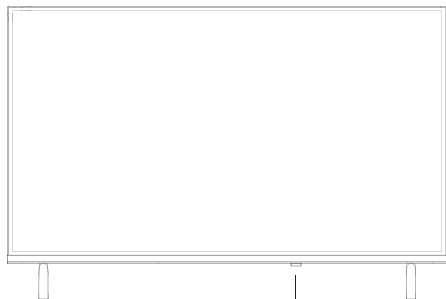
кнопка питания/инфракрасный датчик/индикатор питания
